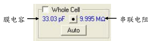
图 23. MultiClamp 700B 的膜电容补偿功能
