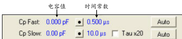
图 22. MultiClamp 700B 电极电容的补偿功能
