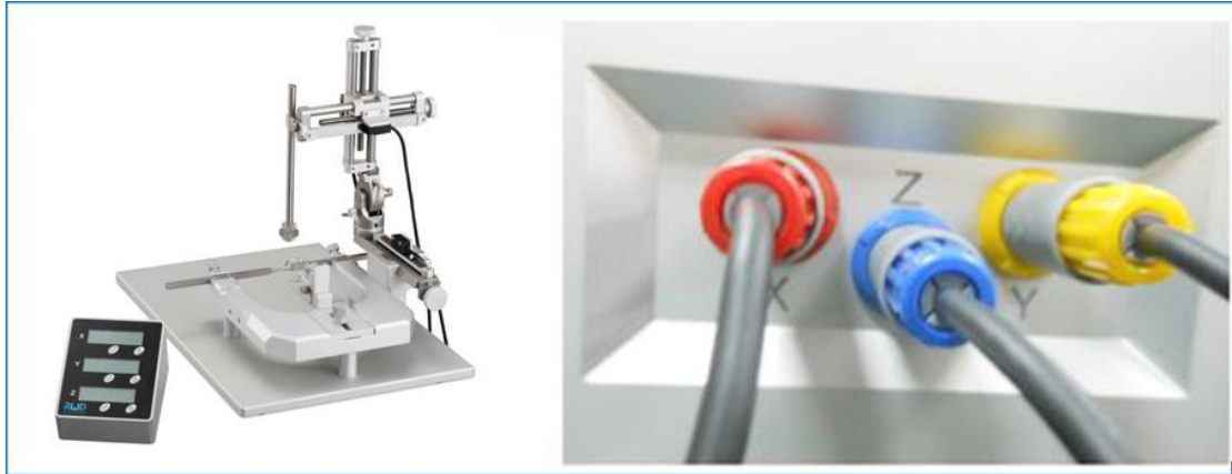
图 2 定位仪 X、Y、Z 轴传感器与数显模块的连接示意图
