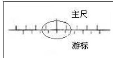
如图7 游标刻度线与主尺刻度对齐示意图
