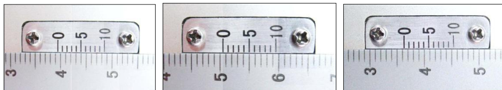
如图8 游标卡尺读数实例（从左往右依次为39.5mm, 50.5mm, 36.3mm）
