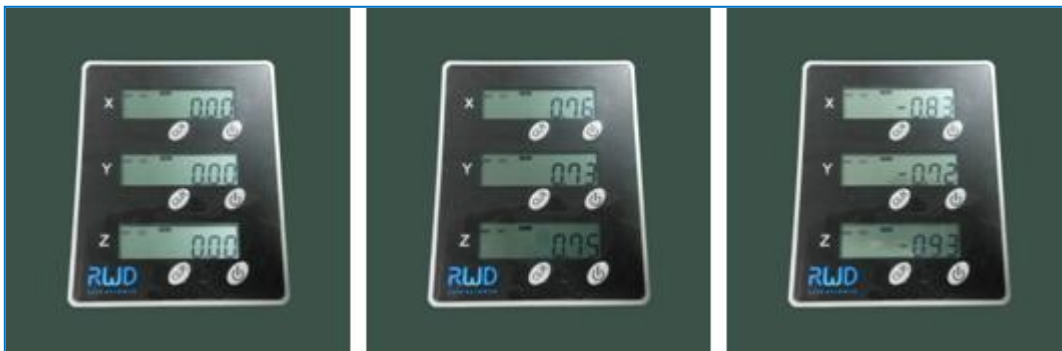
图 3 X、Y、Z 轴归零以及坐标值实时显示示意图
